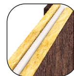
Наполнитель - минеральная плита + гипсокартон
